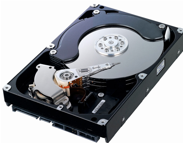
Figure 6: Esempio di disco elettromeccanico: in evidenza i piatti nichelati (3 in foto) e le testine sulla cui estremità è montato il solenoide di lettura/scrittura (non visibile per ragioni di dimensioni)
