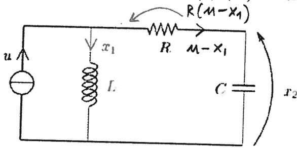
Qualora al circuito inizialmente a riposo venga applicata una corrente costante  $\bar{u}$ , si dimostri che la corrente  $x_1$  nell'induttore può tendere verso il suo valore di equilibrio  $\bar{u}$  con infinite oscillazioni smorzate oppure con una sovraelongazione.
